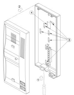
Um das Uniphone zu installieren, öffnen Sie das Gehäuse (indem Sie mit einem Schraubenzieher auf die Unterseite des Uniphones "1" drücken und dann die Vorderseite des Gehäuses "2" öffnen), führen Sie ein Kabel durch das Loch "4" und schrauben Sie es über die Löcher "3" fest.
